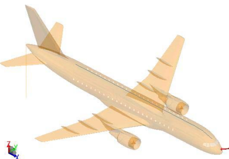
图 9 客机雷击的内部线缆布局的仿真模型
