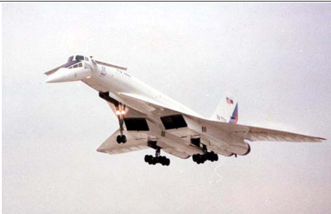
鸭式气动布局机型——俄罗斯图 144 超音速客机
