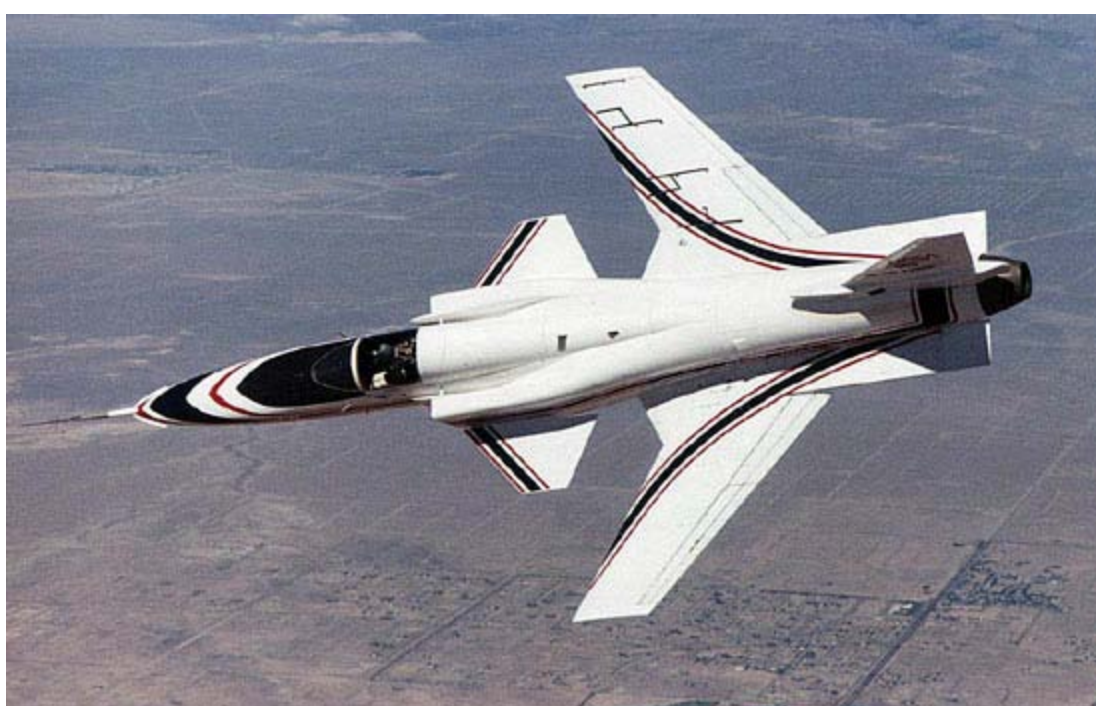
前掠翼气动布局机型——美国 X29 试验机
