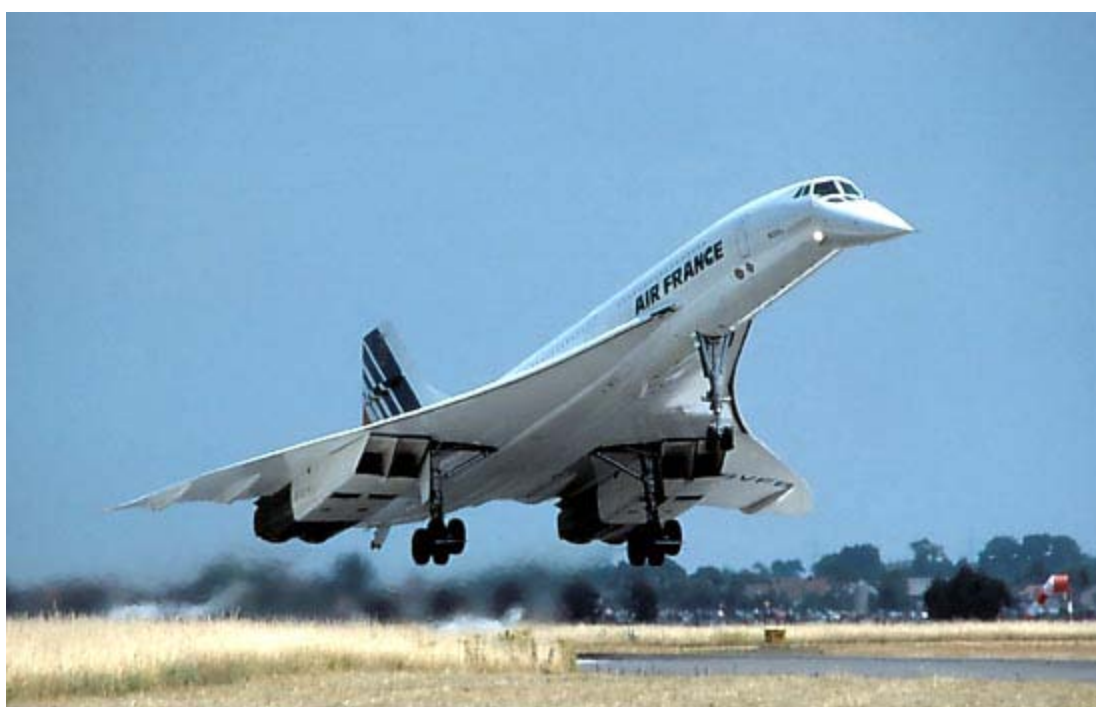
无尾气动布局机型——英法联合研制的协和超音速客机
