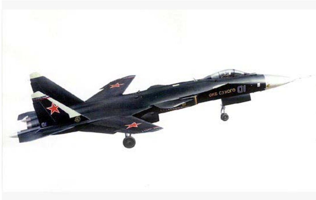
前掠翼气动布局机型——俄罗斯 S37 金雕试验机
