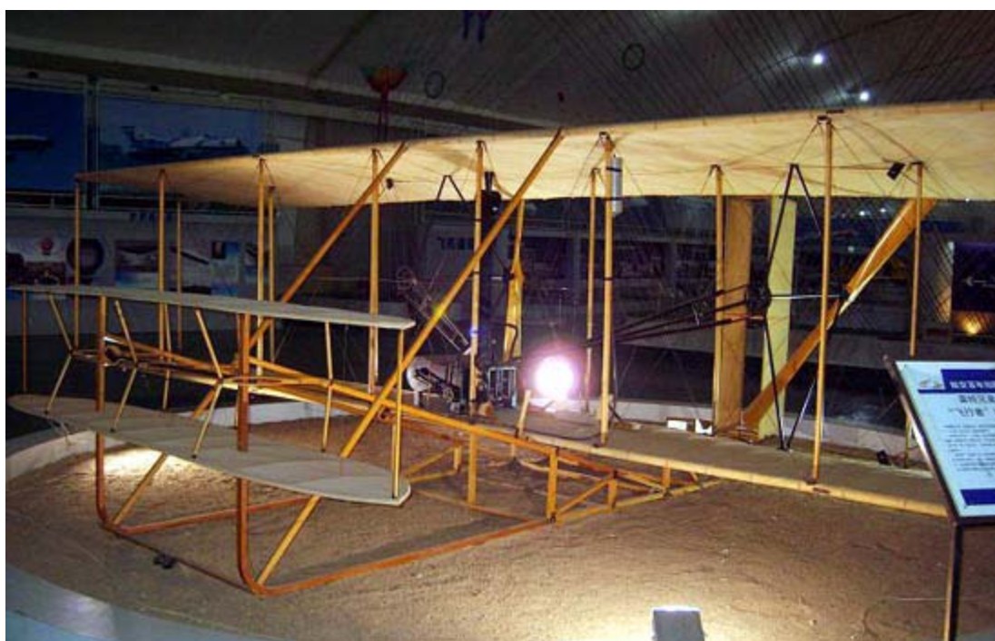
鸭式气动布局机型——世界第一架飞机飞行者一号
