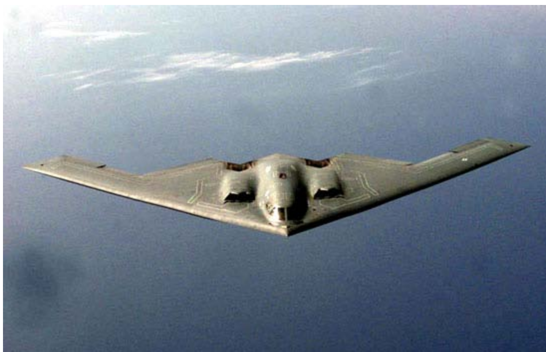
飞翼气动布局机型——美国 B2 隐形战略轰炸机
