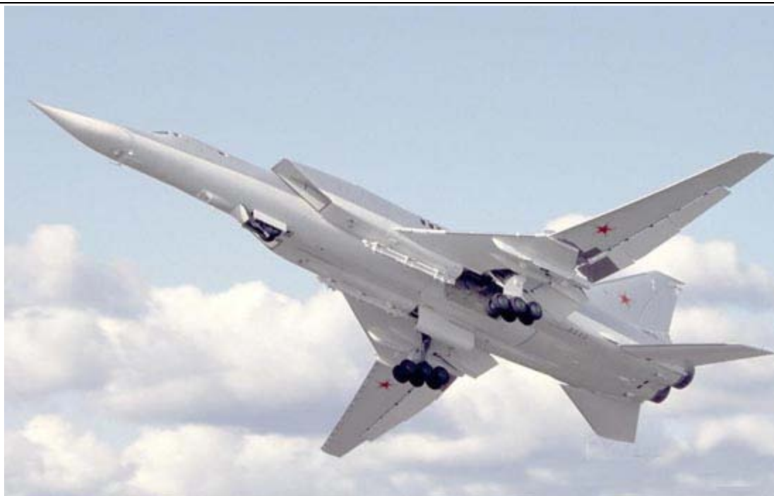
变后掠翼气动布局——俄罗斯图 22 逆火战略轰炸机
